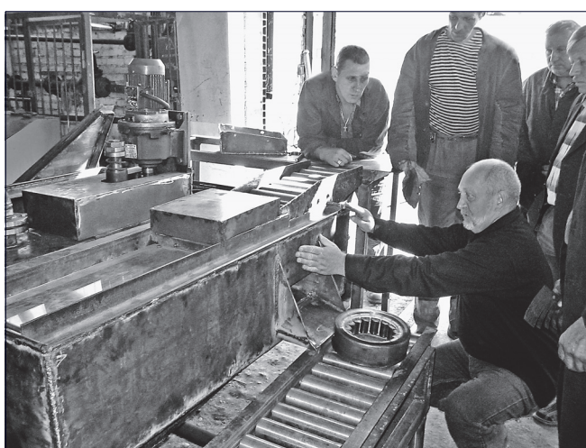
На снимке: рабочий момент — изготовление подшипниковой мойки в РМЦ под четким курированием инженера-конструктора А.П. Зиновского.
