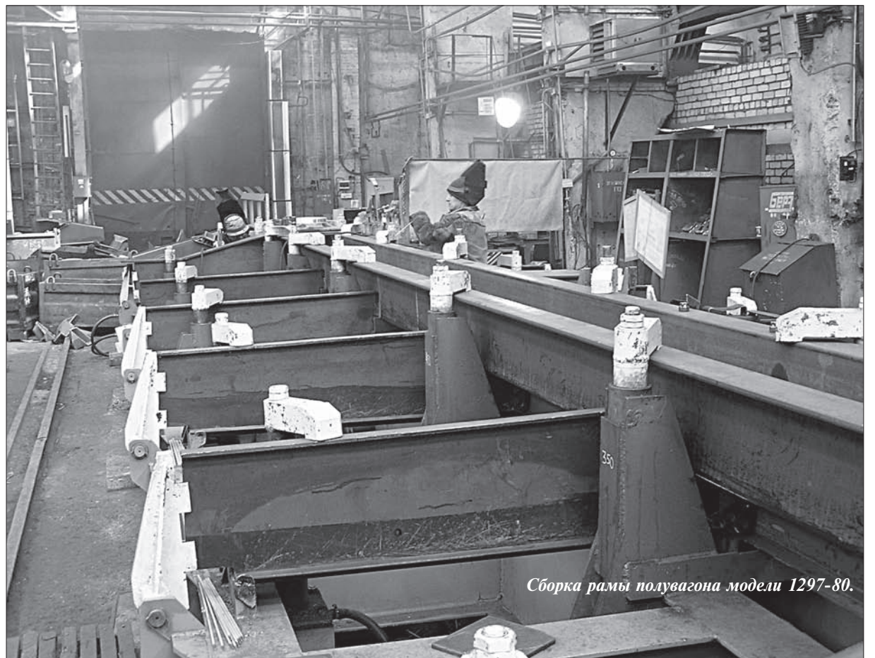
Позиция обварки кузова нового полувагона
